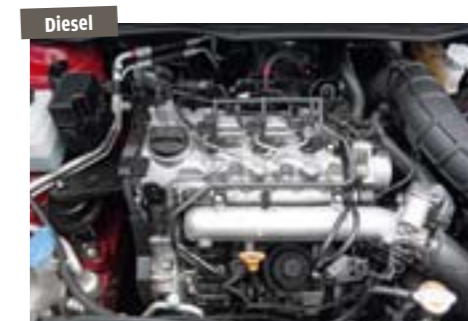
Der Dreizylinder-Diesel mit 75 PS ersetzt im i20 den bislang angebotenen 1,4-Liter-Diesel mit 90 PS
